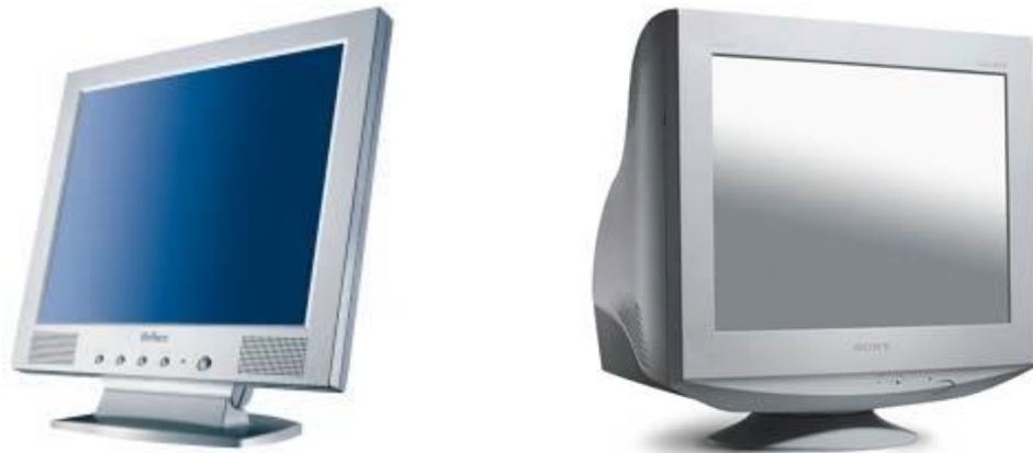
Figura 8. Monitor TFT (izquierda) y CRT (derecha)
