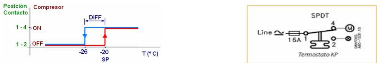
Fig. 5: Contactos para termostato DANFOSS.
