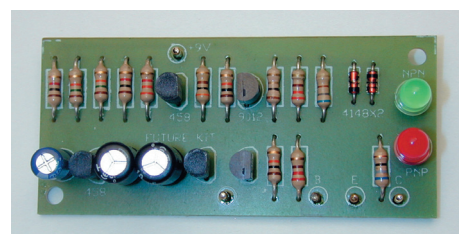
Kit terminado. Es recomendable instalarlo en una caja de plástico, junto a la pila y los conectores necesarios para la conexión del transistor en prueba.
