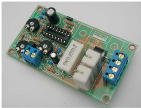
Fotografía 6. Montaje de las resistencias de potencia en forma vertical y horizontal.
