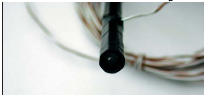
El diodo led bicolor puede ser colocado en la parte superior del bolígrafo.
