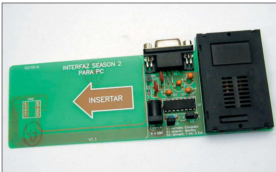
La Interfaz Season II plus, es la mejor herramienta para el control y estudio de comunicaciones y protocolos del estándar ISO7816.
