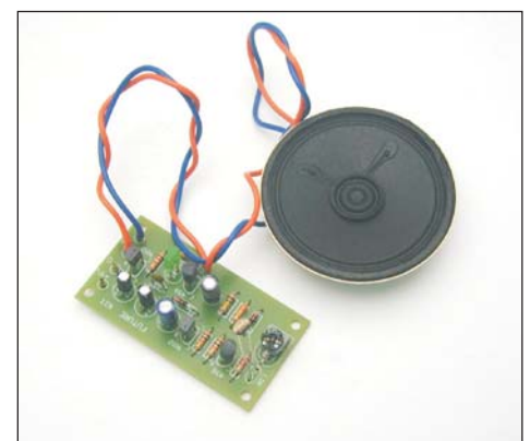
Apariencia del Kit terminado. En caso de que sea necesario, el LDR puede separarse del circuito utilizando cables finos. Es recomendable no superar los 3 metros para evitar interferencias.
