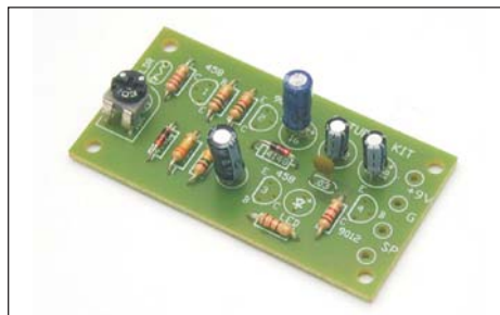
Prestar atención al montar los capacitores electrolíticos respetando su polaridad. En el impreso viene marcado el polo + que corresponderá con el terminal más largo. Los diodos también poseen una orientación que debe respetarse.
