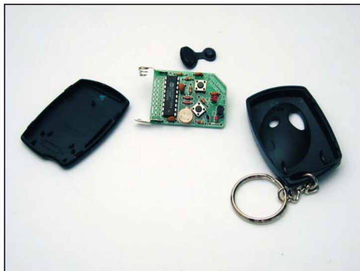
Foto2: Mando emisor montado, y preparado para su ensamblaje.
