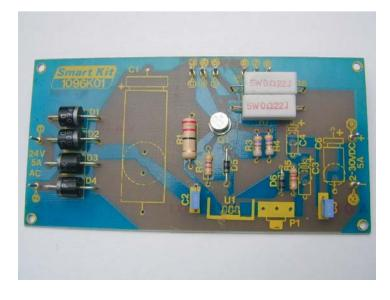
Antes de poner en marcha el circuito, es conveniente realizar una revisión general del montaje y de todas sus soldaduras para verificar que todos los componentes estén adecuadamente ubicados y las soldaduras correctamente aplicadas y ningún corto circuito entre ellas.
