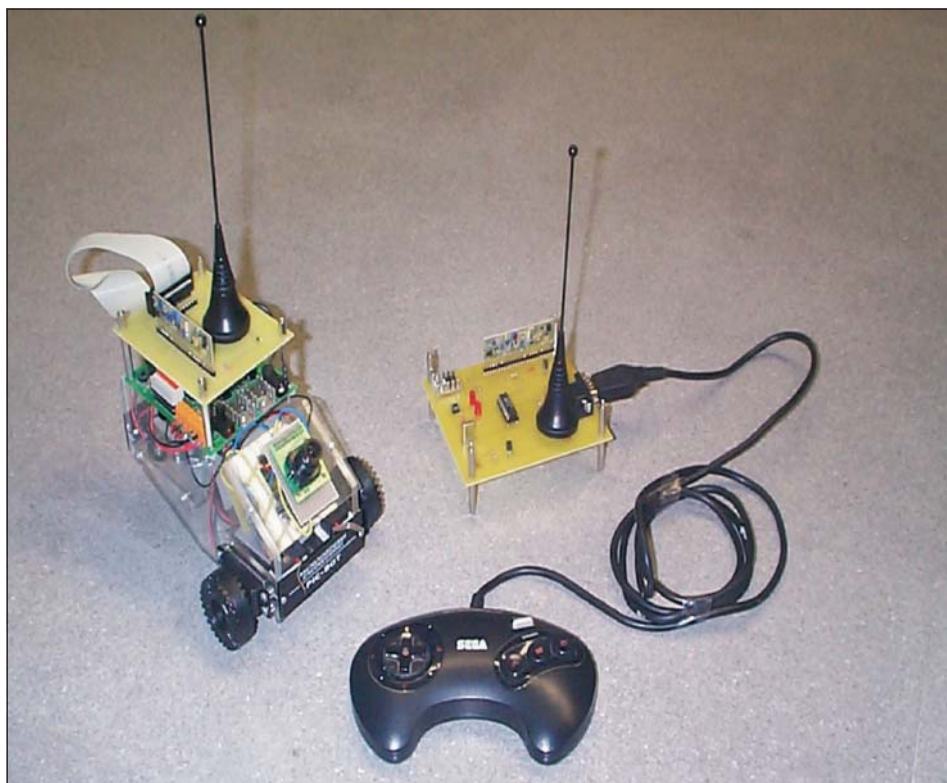
Fotografía de un microbot vigilante con su cámara de visión controlado por R-F..
