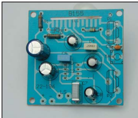
Figura 3. Colocación de los condensadores.
