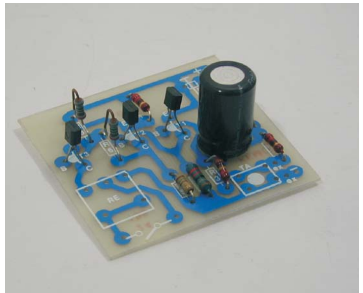
Figura 3 – En el montaje del transistor tener cuidado con su posición, ya que tiene polaridad, lo mismo el condensador
